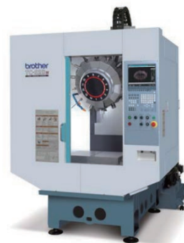
ブラザー製 TC-S2DN ワークサイズ:500x400x300(mm) 主軸回転速度:10000回転(1/min)
